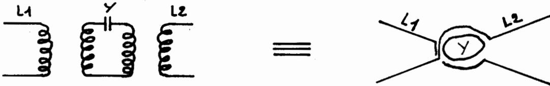
Le couplage entre L1 et L2 (perpendiculaires entre eux) est assuré par Y qui est une bille de YIG. La résonance du circuit est la fréquence de résonance du YIG. On réalise des filtres en associant plusieurs circuits similaires comme le montre le schéma ci-dessous.
